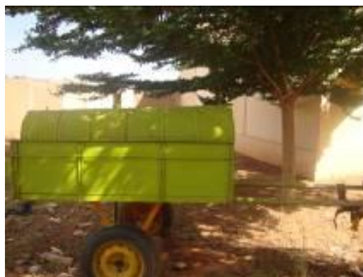
Deux barriques soudées constituant un réservoir sur charrette pour l'apport d'eau aux plants.
